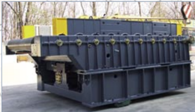
rulliera per laminazione alluminio rolling-mill for rolling aluminium
