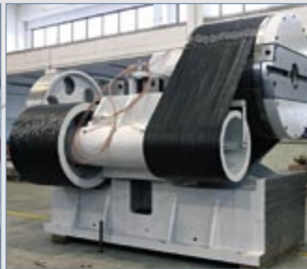
testa porta pezzo per rettifiche cilindro laminazione head holding the workpiece for the rolling cylinder rectifications
