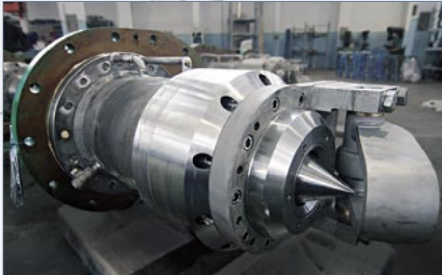
iniettore per turbine Pelton injector Pelton turbine
